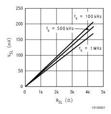
FIGURE 5.  $\Delta \rm V_{SL}$  vs  $\rm R_{SL}$
